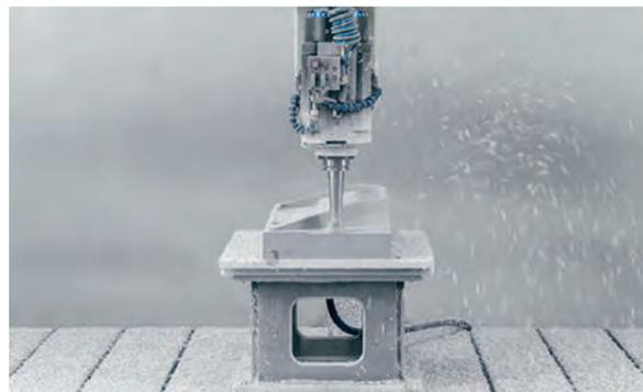
Die Basis für die Fertigung der Formen und Modelle bilden 2D-Zeichnungen oder 3D-Daten, und natürlich die Ideen und Vorstellungen unserer Kunden. Die Umsetzung mittels CNC-Technologie bietet dabei die größtmögliche Präzision.
